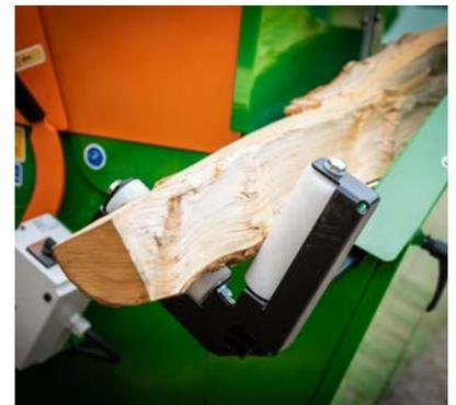
Die Wippverlängerung sorgt dafür, dass auch lange Holzscheite sicher gehalten werden. Über Rollen lässt sich das Scheit leichtgängig zum nächsten Schnitt bewegen.
