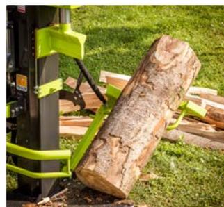
Mit dem serienmäßigen Stammheber entlasten Sie den Rücken: er bringt jeden Holzstamm bequem zur Maschine und in Spalt-Position.
