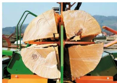
Das hydraulisch verstellbare Spaltmesser teilt auch das längste Holz immer mittig.
