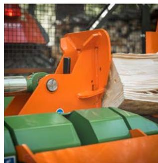
Das robuste Druckstück wird mit voller Kraft bis ans Spaltmesser gedrückt. So wird auch fasriges oder astreiches Holz mühelos zur Gänze durchgespalten. Die präzise Führung sorgt für eine lange Lebensdauer.
