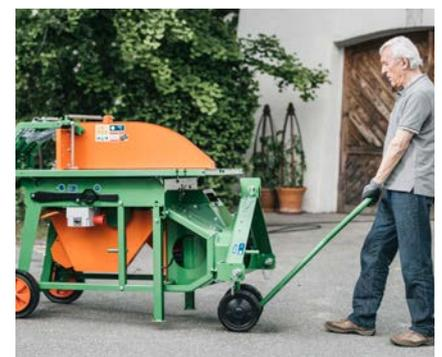
Eine Transporthilfe (serienmäßig bei Zapfwellenantrieb, optional für E-Antrieb) für komfortable Manöver am Hof für die Rolltischsäge.
