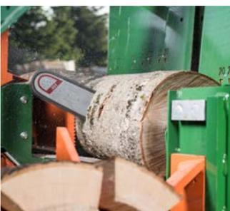
Die Kettensäge mit einer Länge von 53 cm kürzt Stämme auf eine gewünschte Länge von 20-50 cm. Der Harvester-Sägemotor sowie die Kettenschmierpumpe sind wartungsfrei.
