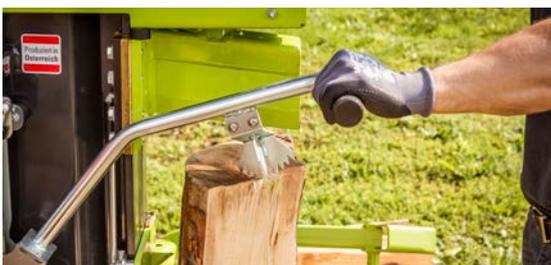
Mit der serienmäßigen Haltekralle wird der Scheit sicher fixiert und das Arbeiten besonders einfach.
