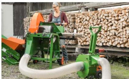
Über einen 2-m Saugschlauch ( $\varnothing$  15 cm) und einen 10-m-Druckschlauch ( $\varnothing$  12 cm) werden die anfallenden Späne abgesaugt.
