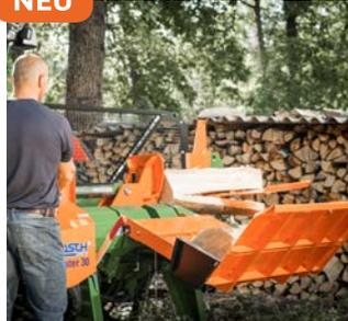
Der hydraulische Stammheber bringt schwere Stämme ganz leicht in Spaltposition. Die neue abgescrängte Spaltwanne erleichtert das Nachspalten größerer Scheite und macht die Holzarbeit besonders effizient. Durch die ergonomische Bedienhöhe des Holzaufletisches können Sie anschließend bequem und kraftsparend weiterarbeiten.
