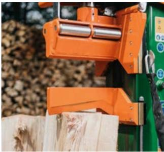
Mit dem zweiteiligen Spaltmesser (Fixomatic-System) oder der Holzhaltespitze kann das Holz ohne lästiges Festhalten beim Spaltvorgang fixiert werden.
