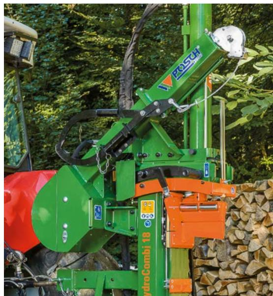
Bei der Seilwinde „750“, 40 m Seil und 750 kg Zugkraft ist die Auslaufgeschwindigkeit unbegrenzt. Für HydroCombi 16, 18, 20, 22, 24 und 26. (Symbolbild)
