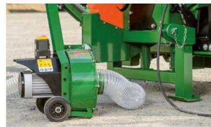
Späneabsauggebläse für Sägespalter.
