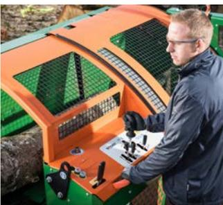
Die hydraulisch angetriebene Stammzuführung sowie das Sägespalten werden bequem via 1-Hand-Joystick bedient.
