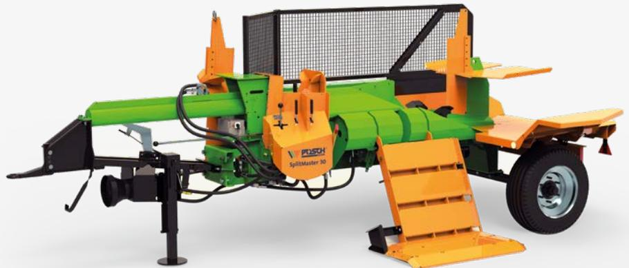
SplitMaster 30 TURBO PZG auf Längsfahrwerk in Arbeitsstellung
