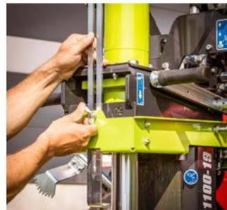
Schneller Vorlauf, Rücklauf im Eilgang und kein Leerlauf durch einstellbaren Spalthub. Zwei Vorlaufgeschwindigkeiten oder AutoSpeed erhöhen die Arbeitsgeschwindigkeit (ab Modell 15Z).
