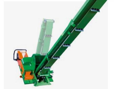
Hydraulisch angetriebenes 2-fach Teleskop-Förderband (5 m) zum Verladen der fertigen Scheite. Artikel-Nr. F5
