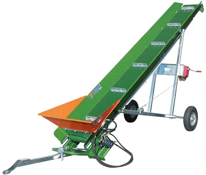
Das Förderband 4/5 m bringt es auf eine Auswurfhöhe von bis zu 3,3 m bei einer Förderband-Geschwindigkeit von 50 cm/s. Das Förderband 6/8 m erreicht eine Auswurfhöhe von bis zu 5 m bei einer Förderband-Geschwindigkeit von 70 cm/s.
