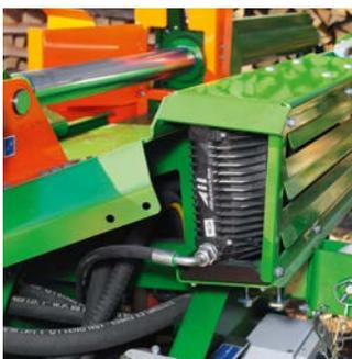
Die professionelle Hydraulikanlage mit großer Grauguss-Pumpe sorgt auch bei niedriger Zapfwellen-Drehzahl für einen schnellen Spaltzyklus (Abbildung mit optionalem Ölkühler).
