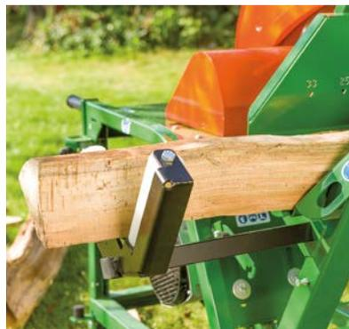
Die Wippverlängerung (F0003779) sorgt dafür, dass auch lange Holzstücke sicher gehalten werden. Über Rollen lässt sich das Scheit leichtgängig zum nächsten Schnitt bewegen.
