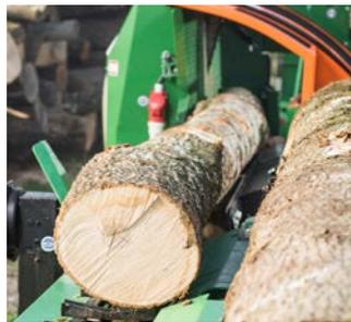
Über ein 2 m-langes Einzugsband erfolgt die Stammzubringung. Mit dem optionalen, mobilen Kettenlängsförderer wird der Arbeitsablauf noch effizienter.
