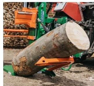
Fast wie von selbst bringt der HydroCombi schwere Stämme in die richtige Position. Die mechanische Stammhebevorrichtung richtet das Holz bequem auf und sorgt für ein rückschonendes und komfortables Spalten. Optionale Seilwinden bringen zusätzliche Arbeiterleichterung.
