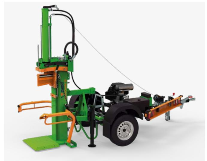
Das Straßenfahrwerk ermöglicht, dass der HydroCombi fahrbar auf Achse ist.
