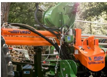
Das Doppel-Zylinder-Spaltsystem sorgt für einen doppelt so schnellen Rücklauf.
