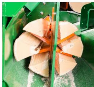
Mit Autospeed wählt der SpaltFix immer die optimale Spaltgeschwindigkeit abhängig vom Spaltvorgang und zeichnet sich durch einen besonders schnellen Vorlauf und Rücklauf aus.
