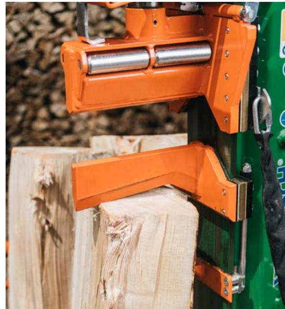
Mit dem patentierten zweiteiligen Spaltmesser (Fixomatic-System) kann das Holz ohne lästiges Festhalten beim Spaltvorgang fixiert werden.
