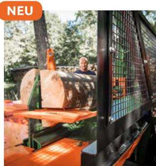
Das serienmäßige Sicherheitspaket (bestehend aus drei Gittern, Gitteraufnahme, verbreiterter Holzauflage sowie Sicherheitsventil) sorgt dafür, dass mehrere Personen ohne etwaige Risiken und Gefahren an der Maschine arbeiten können.
