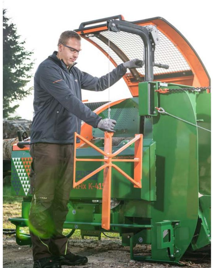
Für einen leichteren Wechsel des Spaltmessers bietet sich eine Handseilwinde optimal an. Artikel Nr. F0004317
