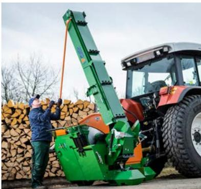
Für den Transport kann das Förderband leicht und schnell manuell einklappbar werden. Die Neigung ist optional auch hydraulisch verstellbar.
