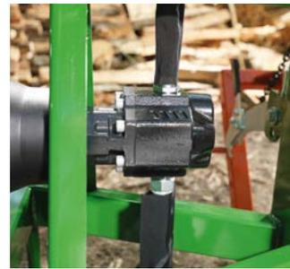
Das optimierte Hydrauliksystem sorgt für ein längeres Arbeiten ohne Überhitzen und überzeugt durch die hohe Pump-Leistung bei geringer Zapfwellen-Drehzahl. Mehr Sicherheit und reduzierte Wartungskosten garantiert der integrierte Tank in der Stehsäule mit doppeltem Boden.
