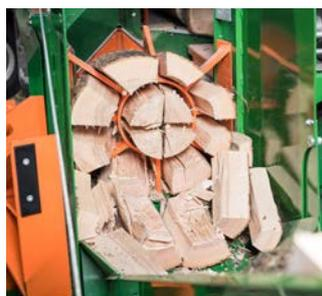
Je nach Steckspaltmesser-variante sind 4, 6, 8 oder 12 Scheite pro Arbeitsgang möglich. Das Messer ist via optionaler Handseilwinde einfach zu wechseln.
