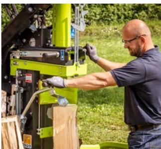
Der Holzstamm bzw. Stammabschnitt kann wahlweise mit 2-Hand-Schaltung in Kombination mit der Haltespitze oder mit der Haltekralle fixiert werden.
