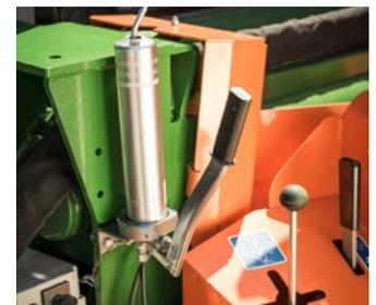
Integrierte Schmiervorrichtung über Handpumpe (optional erhältlich)
