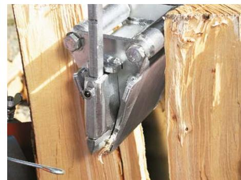
Das aufschiebbar Spezialmesser mit Rollen spart Kraft beim Spalten. Das Holz springt rasch auf und die Rollen am Spaltmesser verhindern ein Hängenbleiben des gespaltenen Holzes beim Retourfahren.
