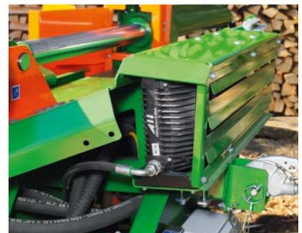
Mit dem optionalen Ölkühler ist ein sicherer Dauerbetrieb bei garantiert. Artikel-Nr. C
