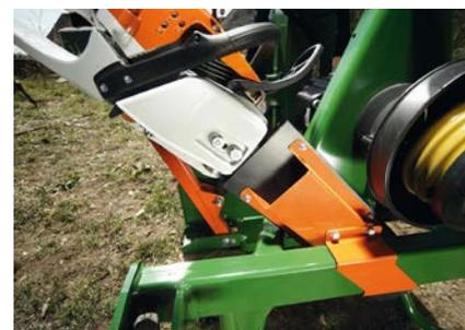
Optionale Motorsägen-Halterung für sicheren Transport und als praktische Ablagemöglichkeit der Motorsäge.
