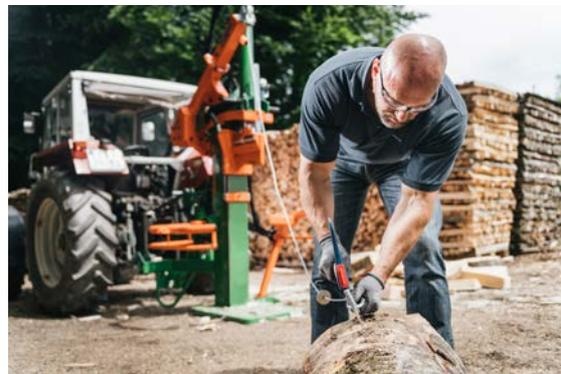
Auch in unwegsamem Gelände zieht die Seilwinde den Holzstamm ohne persönlichen Kraftaufwand bis zum HydroCombi.
