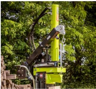
Betriebs-sicheres Hydrauliksystem mit zwei Vorlaufgeschwindigkeiten und lauffruherer Industriergauguss-Pumpe für lange Lebensdauer.
