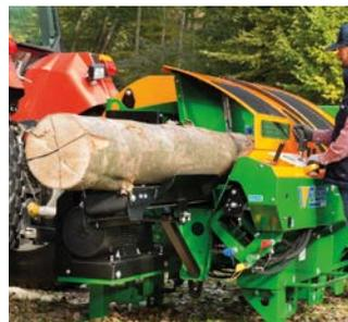
Über das Einzugsband wird der Stamm in Sägeposition gebracht. Der hydraulische Niederhalter und der automatisch lüftende Holzanschlag verhindern ein Klemmen des Holzstammes.
