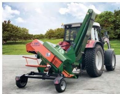
Als Alternative zur Dreipunktaufhängung: Schlepperfahrwerk für den leichteren Transport der Säge (nicht zum Verkehr zugelassen). Nachrüstung möglich. Artikel-Nr. DT oder T
