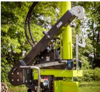
Mit der optionalen Beizeh-Seilwinde kann der Stamm ohne persönlichen Kraftaufwand zur Maschine gezogen werden, wodurch die Arbeit wesentlich erleichtert wird.
