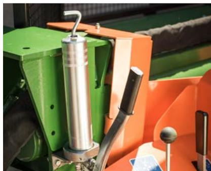
Für eine optimale und zeitsparende Wartung: Optionale Handpumpe (manuell) zur Schmierung des Druckstückes.. Artikel Nr. F0004130
