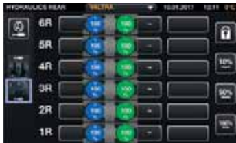
Die Hydraulik kann über jedes Hydraulikbedienelement gesteuert werden. Dies betrifft alle Hydraulikventile! Zusatzhydraulikventile (Front und Heck), Hubwerke (Front und Heck) und Frontlader).
