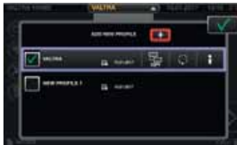
Profile für Fahrer und Arbeitsgeräte, die einfach über jedes beliebige Bildschirmmenü geändert werden können. Alle Einstellungsänderungen werden im ausgewählten Profil gespeichert.
