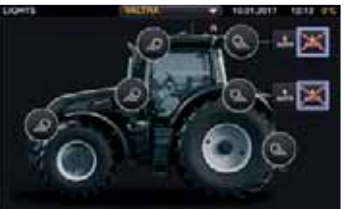
Einfache Konfiguration der Arbeitsscheinwerfer über das Terminal. Ein-/Ausschalter für die Arbeitsscheinwerfer in der Armlehne mit Ein-/Ausschalter für Rundumleuchte.
